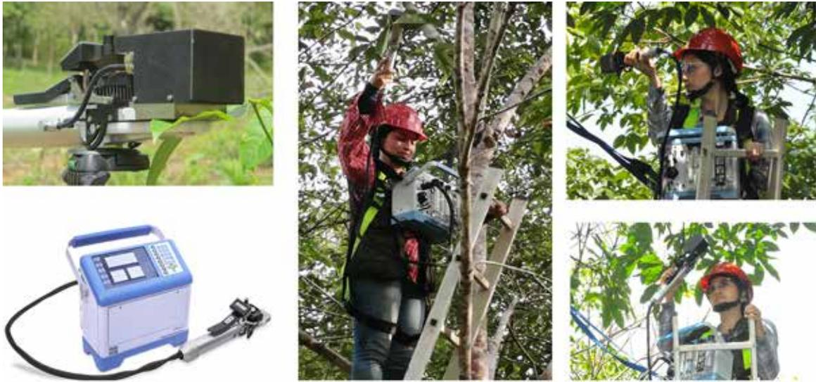
**Figura 3.4.** Evaluación de las variables tasa asimilación de  $\text{CO}_2$  ( $A$ ), tasa de transpiración ( $E$ ), conductancia estomática ( $g_s$ ) y uso eficiente del agua extrínseco ( $WUE$ ) con el equipo de intercambio gaseoso CIRAS-3 (PP-Systems, USA) en los tres Campos Clonales a Gran Escala (CCGE) en el departamento de Caquetá. Fuente: Elaboración propia
